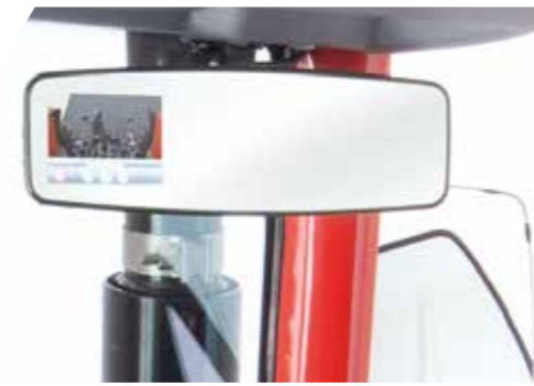
Im IBC-Innenspiegel wird die Rückfahrkamera dargestellt
