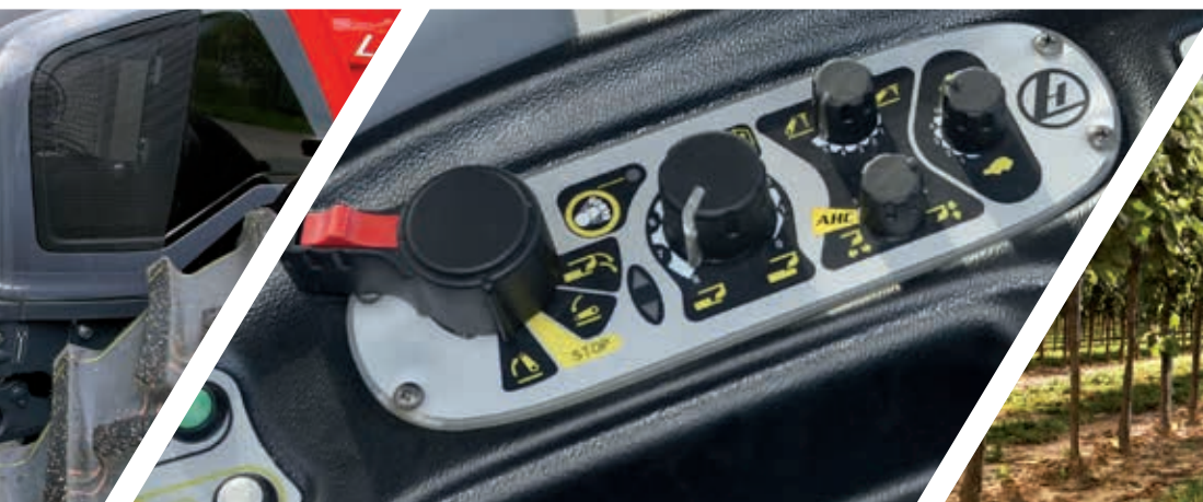
EFH - elektronische Fronthubwerksregelung mit Schwingungstilgung
