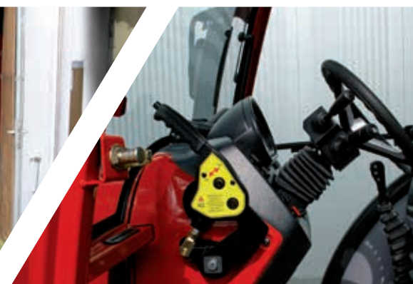
GEOTRAC 94 ep: Sicherheitsperre für Bergeinsätze
