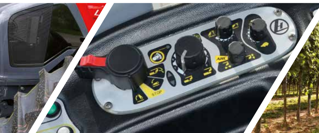
EFH - elektronische Fronthubwerksregelung mit Schwingungstilgung
