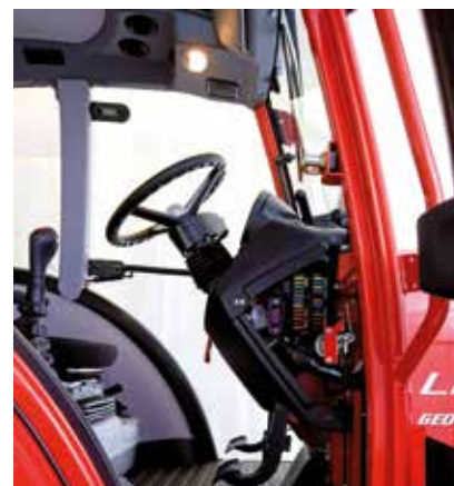
Gut zugänglicher Sicherungskasten
