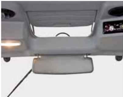
Le „**pare-brise Visio-Chargeur**“ garantit une visibilité optimale sur toute la course d'élévation du chargeur. Intégré dans le toit, un **écran solaire** protège le conducteur des rayons du soleil.
