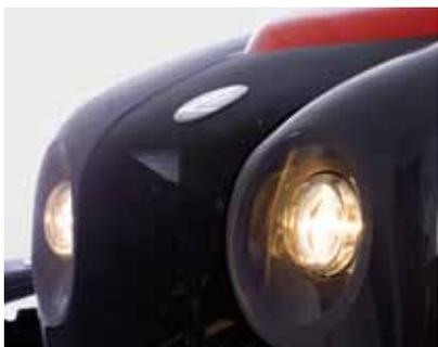
Le GEOTRAC 94 est équipé de série de puissants **projecteurs bi-halogènes**. Sur le toit, 4 projecteurs à ellipsoïde garantissent un éclairage optimal pour travailler avec des outils portés à l'avant.
