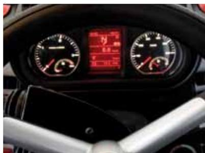
La **centrale d'information avec moniteur I.B.C.** affiche toutes les informations sur le fonctionnement du tracteur. De nombreuses fonctions, en plus de la vitesse et des régimes, peuvent être affichées. Un bouton poussoir situé sur le levier sous le volant permet de varier l'affichage entre l'horaire journalier, la tension de la batterie ou la **consommation**.
