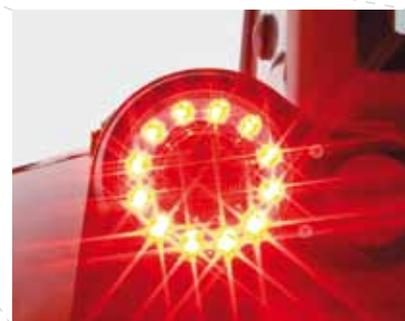
**Feux arrières par LED** – Grâce à leur extrême longévité pouvant atteindre les 20.000 heures, les diodes lumineuses des feux arrière et stop, durent pratiquement une vie de tracteur et cela sans le moindre entretien.
