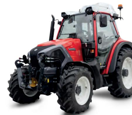
Der Lintrac in der Weinbauausführung ist dank seiner **kompakten Bauweise und Wendigkeit** für Weinbauprofis maßgeschneidert. Die Kabine wird nach oben hin schmaler. Der **Auspuff** beim Weinbau-Lintrac ist auf Wunsch **nach unten** gerichtet.
